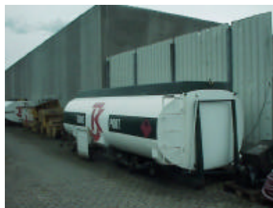
Olietank på containerlad
