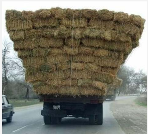
Figur 18. Høje, lette køretøjer er særligt udsatte for at vælte, hvis de påvirkedes af kraftig sidevind. Hvis kraftpåvirkningen på køretøjet er sammensat, så den resulterende kraft falder uden for det rektangel, som køretøjets hjul danner, vil kræfterne give anledning til et moment, som ikke kan modvirkes, og køretøjet vil vælte.
