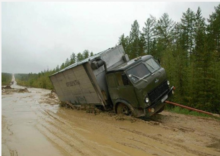
Figur 2. Køretøj på udenlandsk vej, der har problemer med bæreevnen og med afledningen af vand. Ukendt fotograf.
